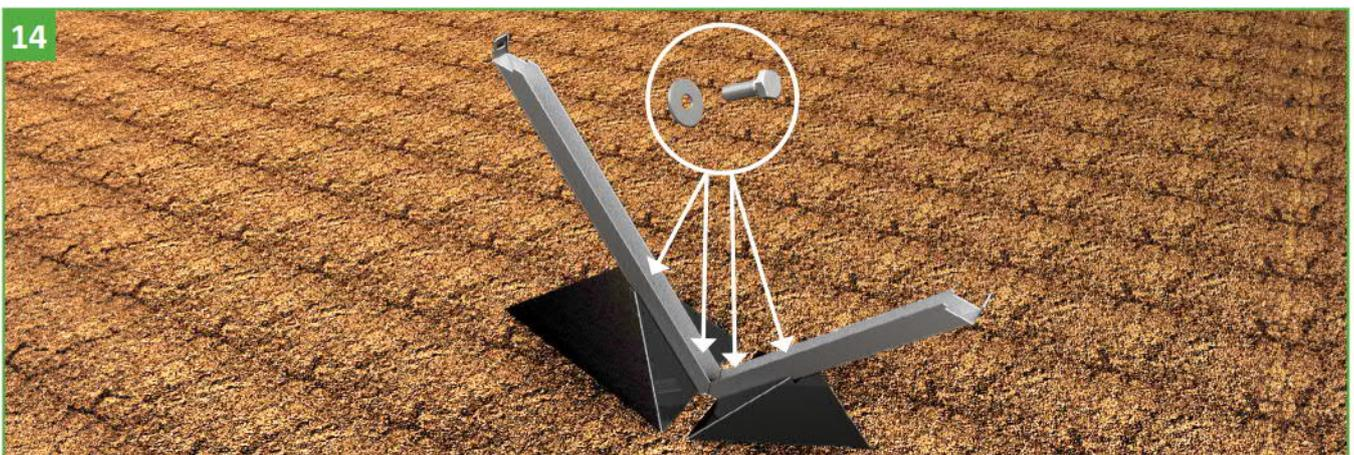
Die Spannmuttern sind in der Grundplatte vormontiert. Ziehen Sie die vier beiliegenden M8x20 Schrauben nacheinander fest und beachten Sie, dass die Unterseite des GEGRADA® Solar Aufständerungsprofil und das GEGRADA® Solar Basisplatte vollflächigen Kontakt haben. Anzugsdrehmoment: max. 12 Nm.
