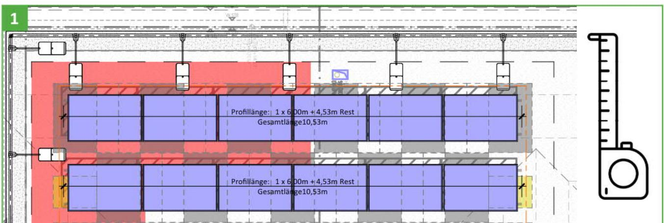
Verlegen Sie die GEGRADA® Solar Basisplatte und die dazwischen liegenden GEGRADA® Solar Distanzplatte gemäß Plan auf dem Dach.
